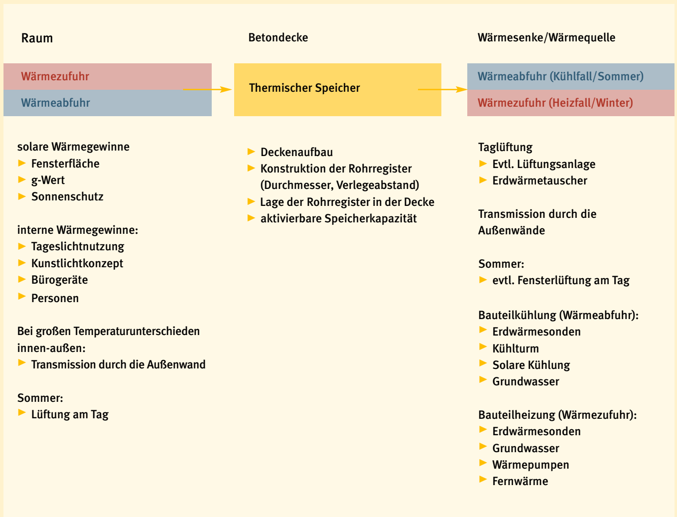
Abb. 8 Energiebilanz für den beheizten/gekühlten Raum mittels Betonkerntemperierung
