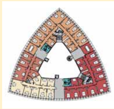
Abb. 19 Bürogebäude Energon in Ulm – mit knapp 7.000 m 2 Nettogrundfläche das weltweit größte Bürogebäude nach Passivhauskonzept (2006). Die Betonkerntemperierung sorgt zusammen mit einer umfassenden Wärmedämmung, mechanischer Be- und Entlüftung sowie beweglichem Sonnenschutz für komfortable Arbeitsbedingungen. Architektur: oehler faigle archkom (Bretten), Energiekonzept: ebök Ingenieurbüro (Tübingen), Monitoring: Steinbeis-Transferzentrum Energietechnik, Fachhochschule Ulm. Foto und Grundriss: Software AG Stiftung, Darmstadt
