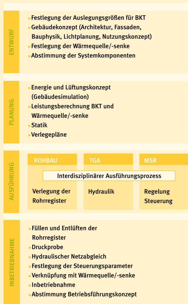
Abb. 11 Integraler Planungs- und Ausführungsprozess für thermoaktive Bauteilsysteme (nach Zent-Frenger)
