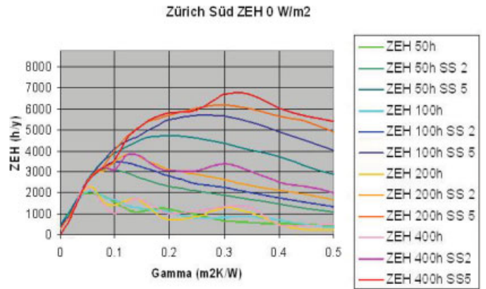
Bild 2. Die Nullenergiestunden (ZEH) eines Raumes als Optimierungsgröße in Funktion des Gewinn-zu-Verlustfaktors \gamma für verschiedene Werte der Zeitkonstanten \tau : 50 h, 100 h, 200 h und 400 h, je ohne, mit innerem (SS 2) und äußerem (SS 5) Sonnenschutz
